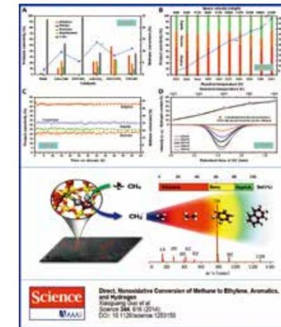
晶格限域的单铁中心催化甲烷无氧直接转化制乙烯和芳烃新过程：反应温度为 109°C 时，甲烷单程转化率为 48%，产物乙烯和芳烃的选择性大于 99%。该过程与传统天然气利用途径相比，摒弃了高能耗的气化单元，而且反应本身无二氧化碳排放，为未来天然气和页岩气的高效利用提供了一条新途径
